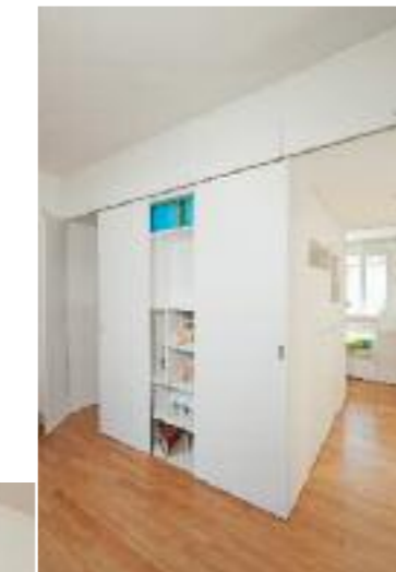
Der Kinderbereich ist um eine frei stehende Schrankbox organisiert, wodurch Räume auch hier abgetrennt oder zugeschaltet werden können.
